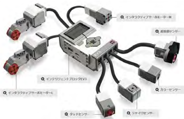
図4 マインドストームのセンサー・モータ系ハードウェアシステム
