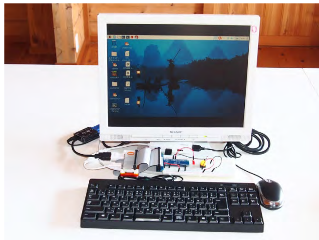
写真 1. RaspberrPi Zero で構築したパソコン
