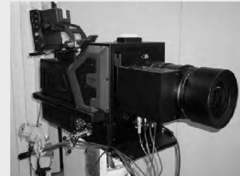
フル解像度カメラ(2010) - 2.5 in. 33M-pixel CMOS 3板 - 65 kg (カメラヘッド)
