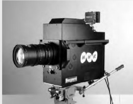
試作DGカメラ (2002) - 4板 2.5 in. 8M-pixel CCD - 80 kg (カメラヘッド)
