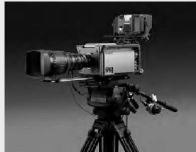
小型軽量カメラ(2010) - 4板DG 1.25 in. 8M-pixel CMOS - 20 kg (カメラヘッド)
