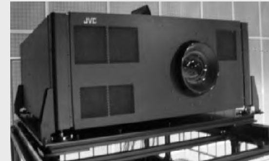
フル解像度プロジェクタ(2009) - 33M-pixel LCOS 3板 - 明るさ : 9000 lumens
