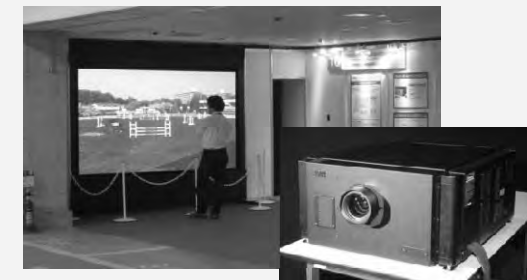
120 Hz SHVプロジェクタ - フレーム周波数120 Hz - e-shift RGB画素ずらし
