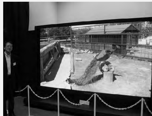
145インチSHV PDP (2012) - 画素ピッチ 0.417 mm
