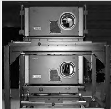
DG プロジェクタ (2001) - 2板 8M-pixel LCOS × 2台 - 92kg x 2
