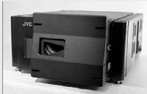
小型プロジェクタ (2010) - 3素子 8M-pixel (e-Shift) - 50.5 kg
