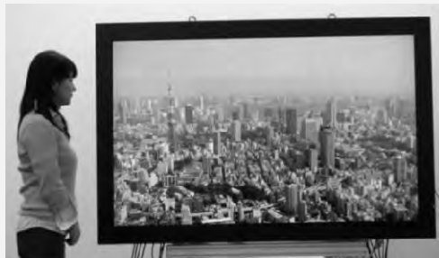
フル解像度85 inch LCD (2011) - 画素ピッチ0.25mm - 輝度 : 300cd/m 2
