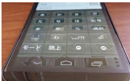
図 2 テンキー用の指ガイド穴が開いた保護シートが貼られた UA 携帯 Galaxy Nexus 版。
