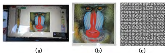
図 14 モニタ画像をカメラで読み取ったときの透かし抽出 (a)カメラ撮影画像, (b)切り出し画像, (c)抽出スペクトル
