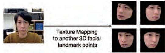
図4 別の 3 次元顔器官点に合わせてテクスチャマッピングした顔モデルの例
